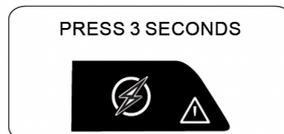
Si la batería de su automóvil tiene bajo voltaje (menos de 2V), mantenga presionado el botón durante 3 segundos (la pantalla muestra "LISTO") para forzar el arranque de su automóvil. **¡No realice un cortocircuito, de lo contrario, puede causar peligro!**
