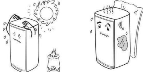
¿Está el lugar expuesto a la luz solar directa o demasiado cerca del horno y otras fuentes de calor? Disipación de calor deficiente, compruebe si hay suficiente espacio de refrigeración alrededor del producto
