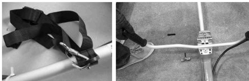
2. Monte el mango en la máquina. Primero suelte los tornillos hexagonales internos, luego tome las manijas derecha e izquierda en el centro del soporte de la manija, monte el soporte de la manija y apriete los tornillos internos lo suficiente.
