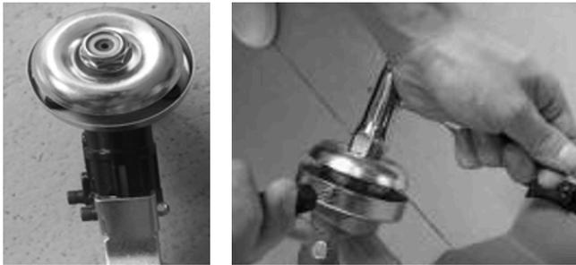
Coloque el cabezal de corte de nylon. Retire el otro escudo después de soltar la tuerca. Aún sostenga la brida, tome el cabezal de corte de nylon en el eje y gírelo en sentido antihorario, el cabezal de corte de nylon está instalado.
