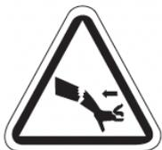
El contragolpe del cable de arranque (retracción rápida) empujará la mano y el brazo hacia el motor más rápido de lo que usted puede soltar, lo que podría causar fracturas, hematomas o esguinces, lo que podría provocar lesiones graves. Al arrancar el motor, tire del cable lentamente hasta que sienta resistencia y luego tire
