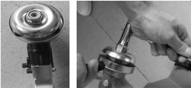
Coloque el cabezal de corte de nylon. Retire el otro escudo después de soltar la tuerca. Aún sostenga la brida, tome el cabezal de corte de nylon en el eje y gírelo en sentido antihorario, el cabezal de corte de nylon está instalado.
