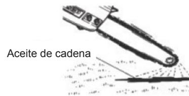
El flujo de aceite de la cadena se puede cambiar con una palanca. Ajuste de acuerdo a sus condiciones de trabajo.
