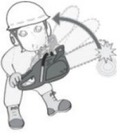
Protéjase contra el contragolpe. El retroceso es el movimiento hacia arriba de la barra guía que ocurre cuando la cadena de la sierra en la punta de la barra guía hace contacto con un objeto. El retroceso puede provocar una peligrosa pérdida de control de la motosierra.
