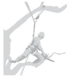
Se puede ayudar a lograr un buen equilibrio en la posición de trabajo mediante el uso de un estribo de pie temporal creado a partir de una eslinga sin fin.
