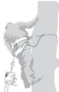
Al mover la sierra de cualquier punto de conexión a otro, los operadores deben asegurarse de que esté asegurada en la nueva posición antes de soltarla del punto de conexión anterior.
