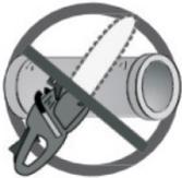
La motosierra sólo debe utilizarse para cortar madera. Está prohibido cortar otro tipo de material. Las vibraciones y el retroceso varían con los diferentes materiales y no se respetarían los requisitos de las normas de seguridad. No utilice la motosierra como palanca para levantar, mover o dividir objetos. No lo bloquee sobre soportes fijos. Está prohibido enganchar herramientas o aplicaciones a la toma de fuerza que no sean las especificadas por el fabricante.
