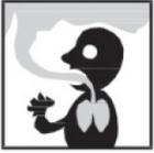
Opere la motosierra solo en áreas bien ventiladas. Nunca arranque ni corra el motor dentro de una habitación o edificio cerrado. Los gases de escape contienen monóxido de carbono peligroso.
