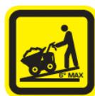
El ángulo máximo de subida de la máquina es de 20°. El ángulo máximo de descenso de la máquina con el cabezal hacia abajo es de 6°.
