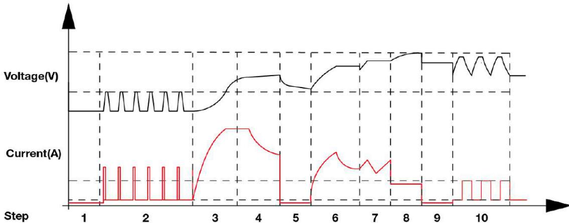
**PASO 1: DIAGNÓSTICO** (Verifique si la batería se ha conectado con el cargador y también verifique el voltaje de la batería).
