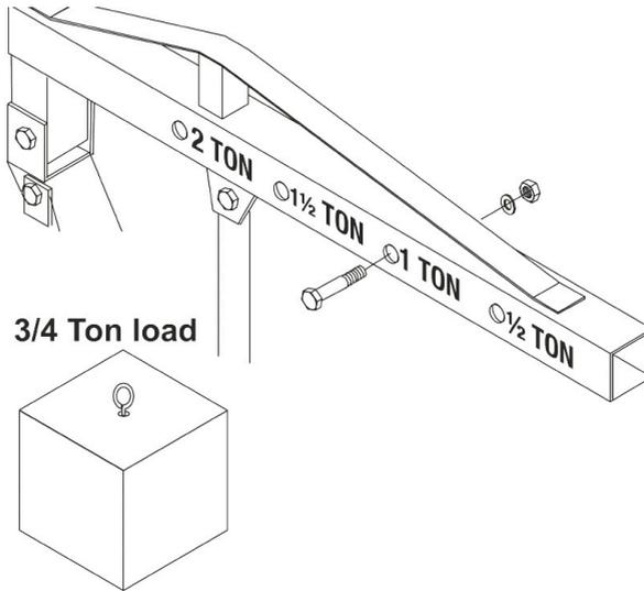
2. Ajuste la extensión de la pluma de modo que el orificio más alejado del extremo del gancho quede alineado con el orificio elegido en la pluma. Asegúrelo en su lugar insertando el perno a través de todos los orificios alineados y apretando en su lugar con una arandela y una tuerca.
