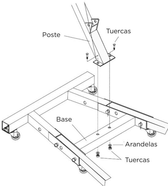
5. Use dos pernos, arandelas y tuercas para sujetar los extremos inferiores de los soportes al interior del marco, luego use un perno, una arandela y una tuerca para sujetar los extremos superiores de los soportes al poste.
