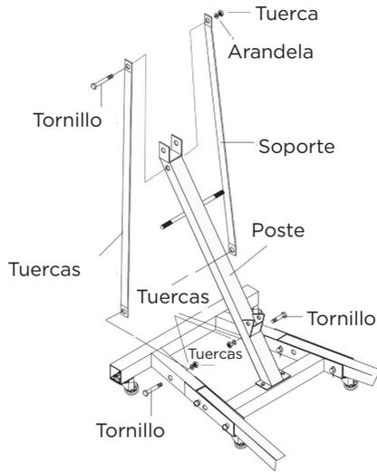
6. Utilice el perno, la arandela y la tuerca para fijar el brazo a la parte superior del poste.
