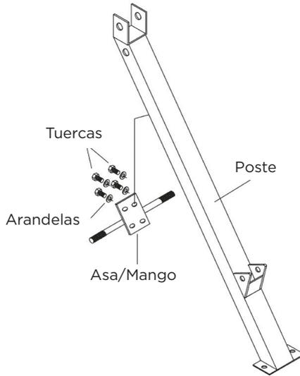
4. Utilice los pernos, las arandelas y las tuercas para asegurar la parte inferior del poste a la base.
