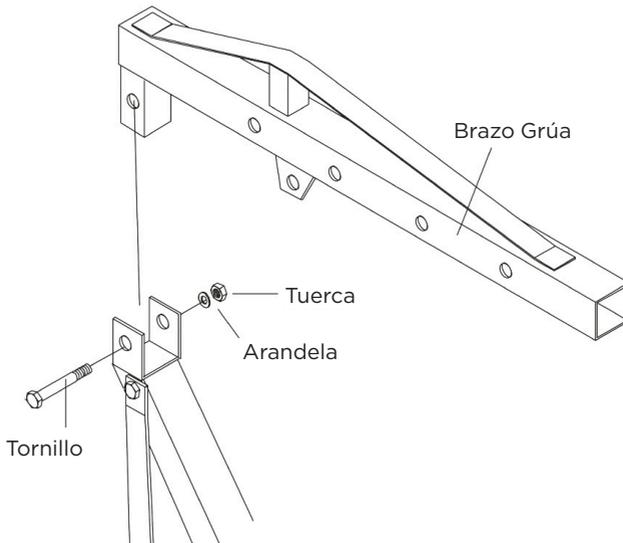
7. Utilice un perno, una arandela y una tuerca para fijar el extremo inferior del gato al poste y otro perno, una arandela y una tuerca para fijar la parte superior del gato a la parte inferior.
