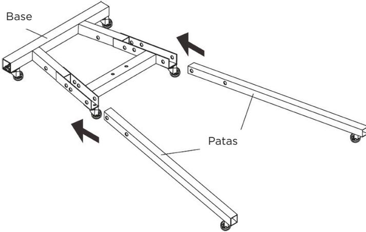
2. Fije las patas en su lugar usando los pasadores de anillo. Para insertar los pasadores de anillo, levante el frente de la base hasta que los orificios queden alineados. Después de insertar los cuatro pasadores de anillo, inserte un pasador en R a través del pequeño orificio al final del pasador de anillo de enseñanza hasta que encaje en su lugar.
