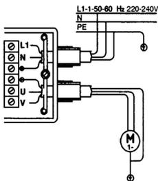
Diagrama de cableado para la conexión de bombas monofásicas de 220V hasta 2,2 Kw.
