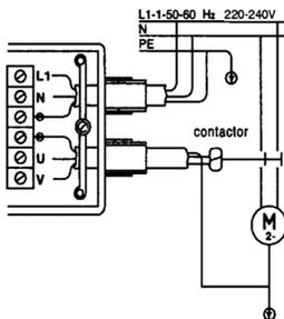
Diagrama de cableado para la conexión de bombas monofásicas de 220V sobre 2,2 Kw a través del interruptor de control remoto
