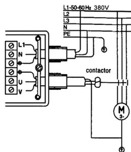
Diagrama de cableado para la conexión de bombas de motor trifásico de 380V a través del interruptor de control remoto.
