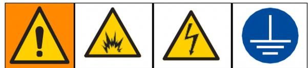
El equipo debe estar conectado a tierra para reducir el riesgo de chispas estáticas y descargas eléctricas. Una chispa eléctrica o estática puede hacer que los vapores se enciendan o exploten. Una conexión a tierra inadecuada puede provocar una descarga eléctrica. Una buena tierra proporciona un cable de escape para la corriente eléctrica.
