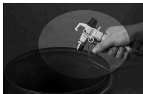
4. Baje la válvula de cebado para abrir la válvula de drenaje y deje que el líquido de lavado circule durante 15 segundos para limpiar el tubo de drenaje.
