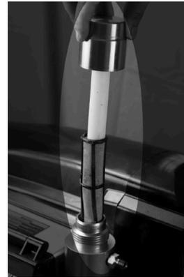
10. Si lava con agua, vuelva a lavar con alcohol mineral o protección de bomba para dejar una capa protectora que evite la congelación o la corrosión.
